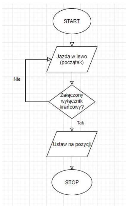
Rysunek 5: Diagram testowej aplikacji ruchu
